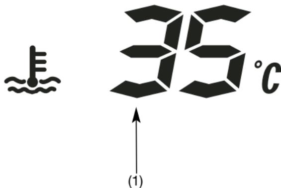
(1) Medidor de la temperatura del refrigerante
