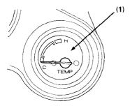
Indicateur de température de liquide de refroidissement
