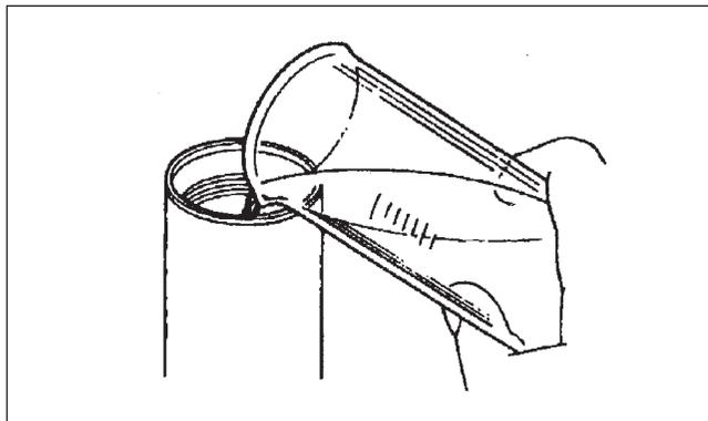
Verser la moitié de la quantité requise de liquide de fourche préconisé dans le tube de fourche.
