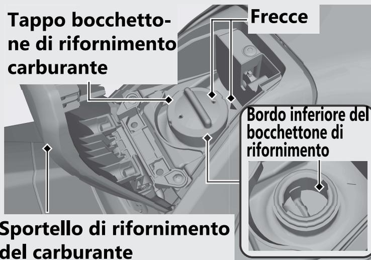
Non rifornire di carburante oltre il bordo inferiore del bocchettone di rifornimento.
