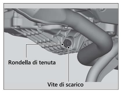
**6.** Per scaricare l'olio, rimuovere il tappo del bocchettone di riempimento olio/astina di controllo livello, la vite di scarico e la rondella di tenuta.
