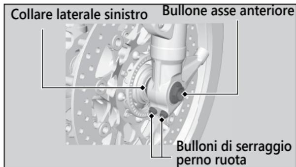
8. Allentare i bulloni di serraggio lato destro del perno della ruota.
