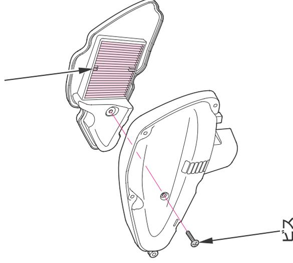
**3** 取外しの逆手順で、新品のエアクリナーエレメントを取付けます。
