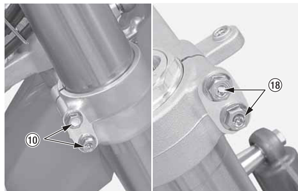
(10) нижние стяжные болты траверсы вилки (18) верхние стяжные болты траверсы вилки
