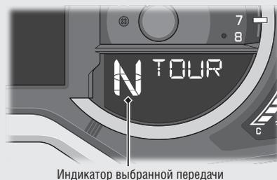
Индикатор выбранной передачи показывает номер включенной передачи следующим образом:
