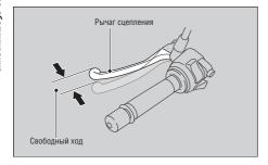
Осмотрите трос сцепления на предмет отсутствия повреждений и признаков износа. При необходимости замены обратитесь к официальному дилеру Honda. Смазывайте трос сцепления смазкой для тросов, имеющейся в торговой сети, чтобы не допустить его преждевременного износа или коррозии.
