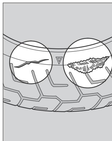
タイヤの全周に、亀裂や損傷、ひび割れおよび釘、石、その他の異物が刺さったり、かみ込んだりしていないかを点検します。道路の縁石などにタイヤ側面を接触させたり、大きな凹みや突起物を乗り越したときは、必ず点検してください。
