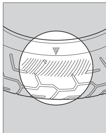
タイヤの接地面が異常に摩耗していないかを点検します。
