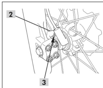
4. Certifique-se de que a lingueta (2) do garfo direito esteja encaixada na fenda (3) do sensor do cubo da roda.
