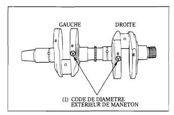
Vérifier les codes de bielles et de manetons de vilebrequin pour déterminer le code de couleur des roulements de rechange.
