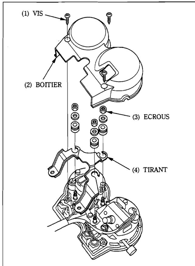
Déposer les deux (courtes) vis de borne du tachymètre. les trois vis (longues) du calibre de température de liquide de refroidissement et la vis de bndage du faisceau.
